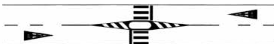
Úttesti járdasziget jelzése
