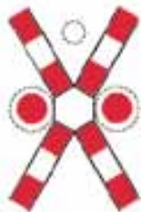
Sorompó nélküli egyszerű vasúti átjáró a vonat közeledtére figyelmeztető világító jelzésekkel
