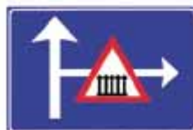
Mellékúti veszély, tilalom vagy korlátozás előjelzése
