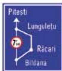
A követendő útvonal előjelzése forgalmi korlátozás esetén
