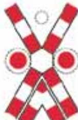
Sorompó nélküli kettős vasúti átjáró a vonat közeledtére figyelmeztető világító jelzésekkel
