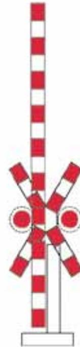
Félsorompós egyszerű vasúti átjáró a vonat közeledtére figyelmeztető világító jelzésekkel
